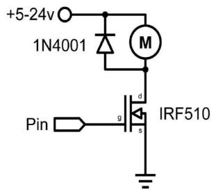
Иногда возникает необходимость в управлении более, чем 40 мA от Arduino. В этом случае может использоваться транзистор MOSFET для коммутации сильноточной нагрузки. В следующем примере MOSFET быстро включается и выключается 5 раз в секунду.
