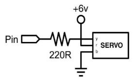
Любительские сервомашинки — это разновидность полу-автономного моторредуктора, который может поворачиваться на 180°. Всё, что нужно — это отправлять импульсы каждые 20 мС. В данном примере используется функция servoPulse для поворота мотора от  $10^0$  до  $170^0$  и обратно.
